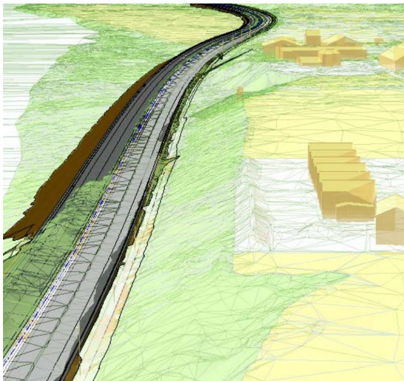
Figur 29: Utsnitt fra vegmodell for ny E6 viser ingen skråningstiltak på østsiden av vegen. Kilde: COWI (2019).
