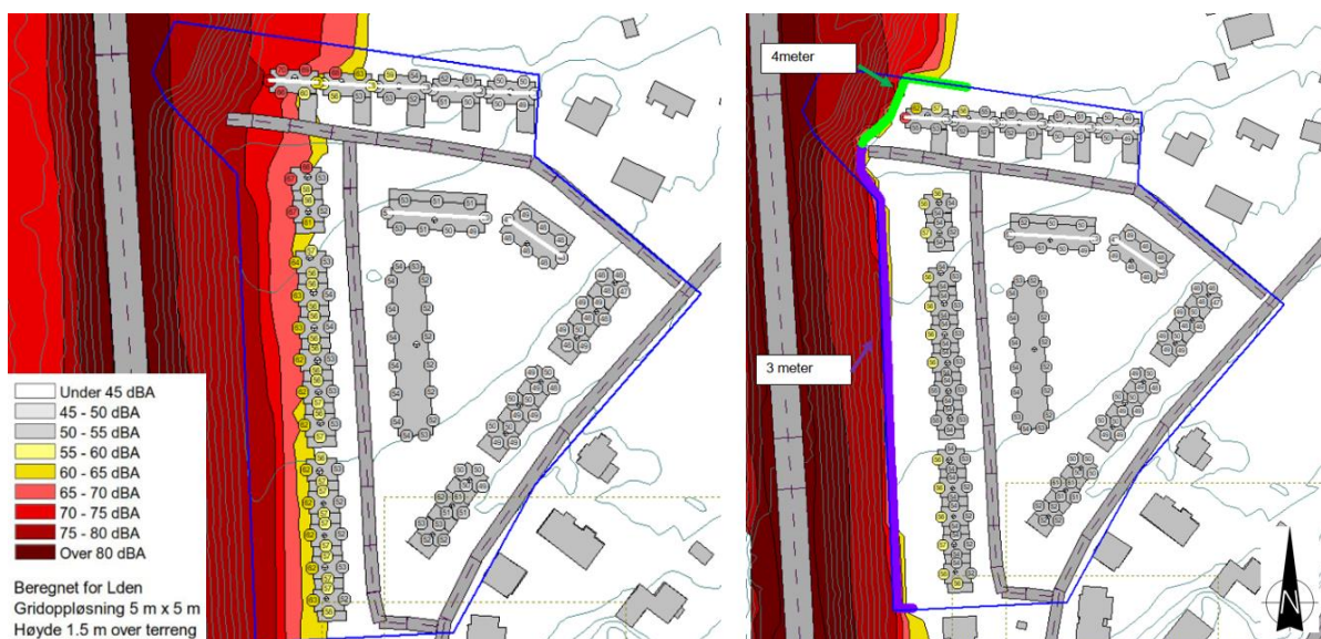
Figur 49: Planområdet uten (til venstre) og med (til høyre) støyskjermingstiltak. Støysoner er vist i 1,5 m høyde, fasadenivåer viser høyeste nivå på fasade uavhengig av etasje. Grønn linje viser støyskjerm med høyde 4 meter og lilla viser støyskjerm i høyde 3 meter.
